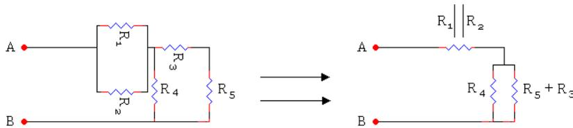
$$R_5 = R_1 // R_2 + R_4 // (R_3 + R_5)$$
