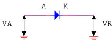
$V_A - V_K >$  Voltaje de unión o rodilla.
