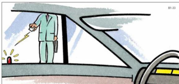
Los rayos infrarrojos se utilizan para transmitir un código invisible a un receptor y que este pueda accionar un dispositivo.
