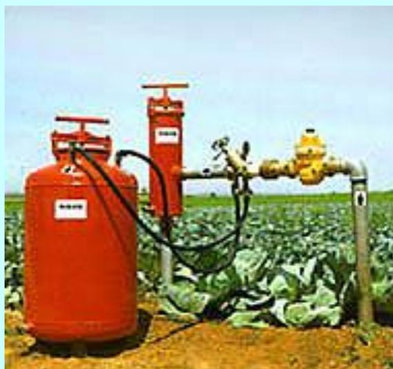
El equipo básico es un tanque conectado a la red a través de dos mangueras; entre los puntos de unión, sobre la línea, se coloca una válvula, que funciona como reguladora de presión. A través del cierre parcial de esta válvula se produce un
