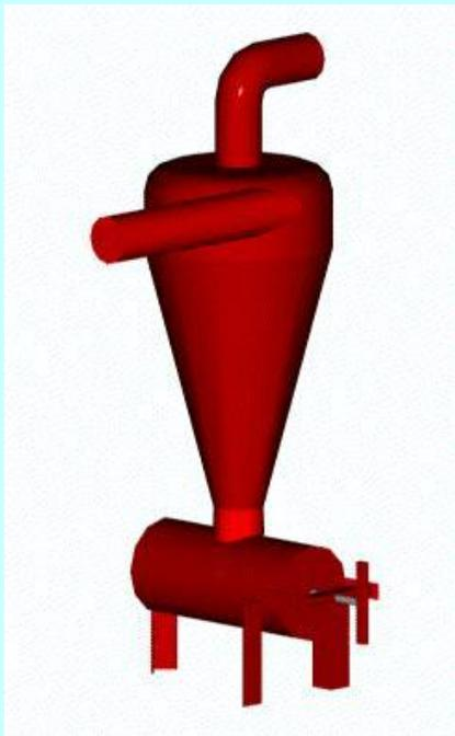
El agua contaminada entra en el hidrociclón, que debe estar situado en posición vertical, por la conducción D1, con un flujo tangencial a la sección cilíndrica, D2. El flujo rotacional origina una fuerza centrífuga. Los sólidos, al ser más pesados que el agua, son desplazados hacia el exterior de la
