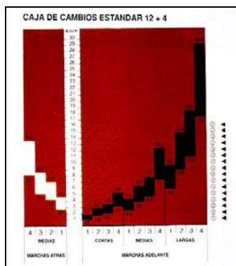
Figura 18.- Escalonamiento real en la caja de cambios de un tractor.
