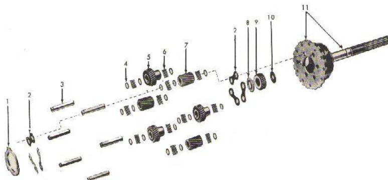
Fig.12 Conjuntos de los planetarios
