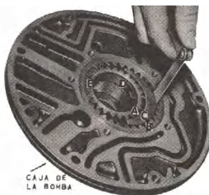
Fig. 8 Componentes de la bomba
