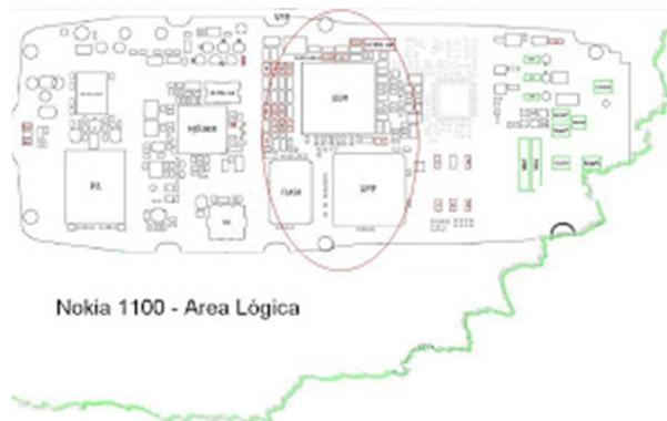
Por último, si aún persiste la falla se deberá realizar un análisis en el manual esquemático del teléfono, en donde se deberá seguir el circuito correspondiente al teclado para verificar continuidad de sus pistas.
