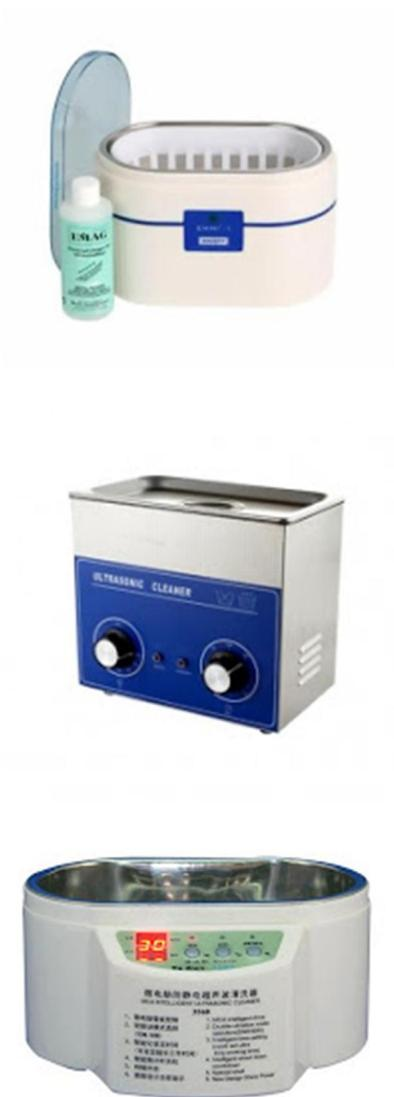
Otra herramienta muy importante para realizar desulfataciones de placas son los limpiadores ultrasónicos, estos equipos tienen una especie de recipiente donde deberán colocar alcohol isopropílico de tal manera a cubrir la placa, después se debe setear el tiempo que podría variar de 1 a 3 minutos, enciende el limpiador y una vez terminado el proceso de limpieza, retiraran la placa y la secan utilizando un soldador de aire caliente.
