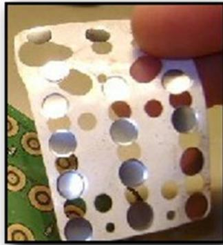
Por tanto, se debe proceder a la limpieza de los contactos de teclado la placa utilizando un borrador de lápiz (preferentemente un borrador blanco) hasta que el cobre del contacto tome brillo, de tal manera aseguremos el contacto de la chapita del myllar con el contacto con el contacto de la placa, posteriormente ensamblar el equipo y realizar la prueba de funcionamiento.
