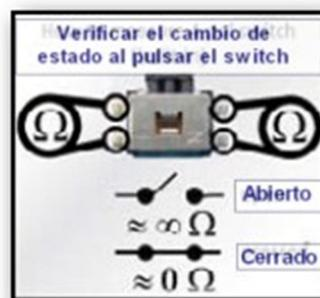
Tener en cuenta que algunos teléfonos, utilizan la tecla de cortar llamadas como switch de encendido, en estos casos se deberá verificar los contactos del myllar correspondiente a esta tecla y realizar la limpieza de los contactos de la placa correspondiente a esta tecla.
