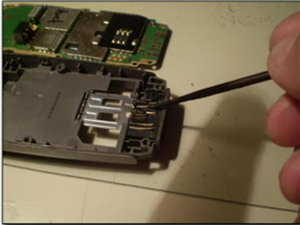
Siguiente, verificar el conector de batería.
