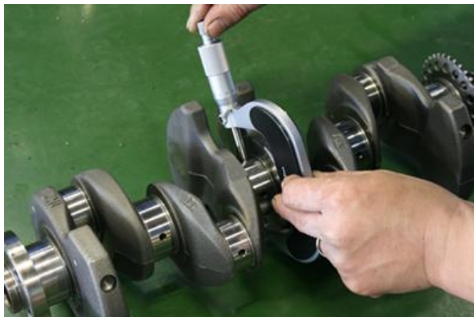
Gráfico 3.3. Medida del desgaste de las muñequillas de apoyo con el micrómetro
