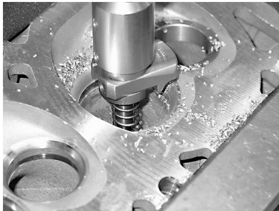
Gráfico 3.13 Rectificado del asiento de válvula
