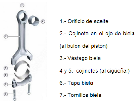
Gráfico 3.9 Componentes del brazo de biela
