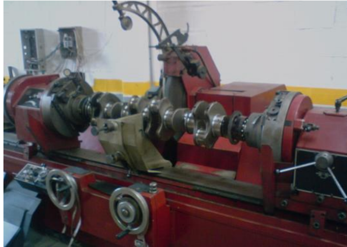
Gráfico 3.4. Máquina rectificadora de cigüeñal
