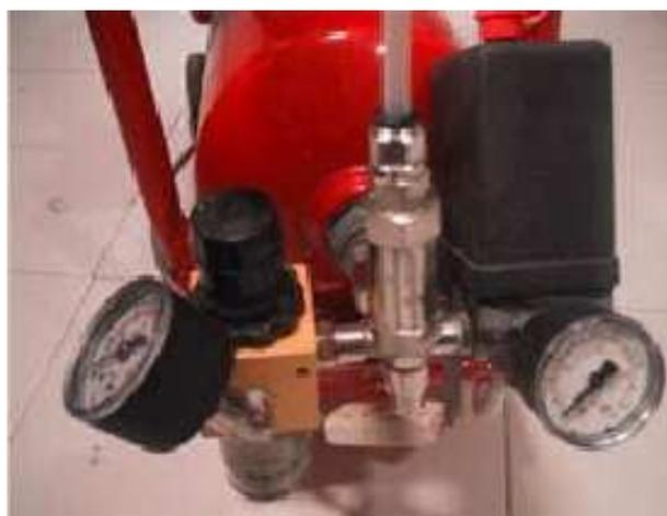
**Vista general y en detalle del compresor, en la vista detalle del lado derecho observamos el manorreductor parte izquierda y presostato parte derecha, y en el centro la válvula antiretorno**
