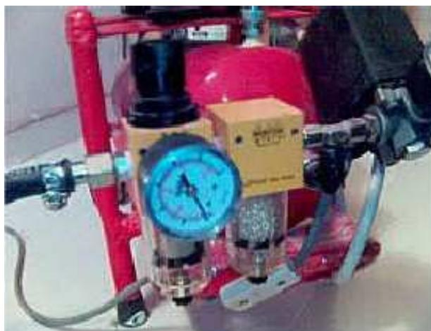
**Vista del segundo filtro instalado**
