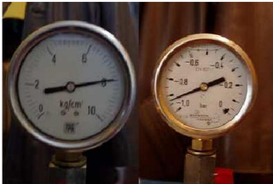
La conclusión es que es un gran compresor, en menos de 3 min., tenemos lleno el deposito de 25L con 8 bar de presión, y en otros 3 min., tenemos el otro deposito de 25L con -0,9 bar de presión, lo cual es mas que razonable, y nos permitirá trabajar en la mayor parte de trabajos que se nos puedan ocurrir (ocasionalmente podremos unir ambos depósitos y tener 50L) además en breve esperamos montar un 2º motor paralelo con lo que los rendimientos mejoraran notablemente.
