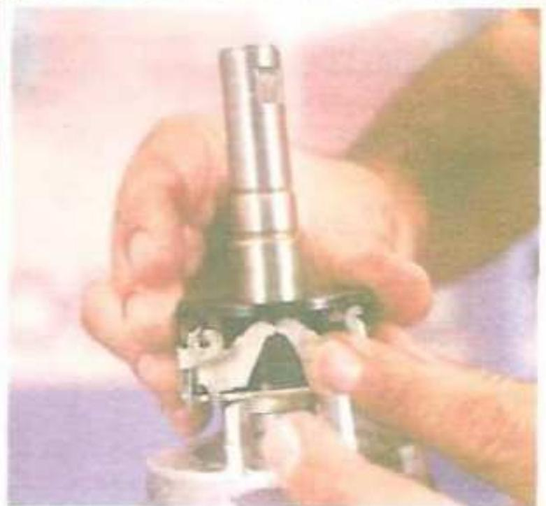
Luego se mete el carrete en el eje del rotor, asegurándose de que las pestañas del soporte entren en las ranuras del carrete.
