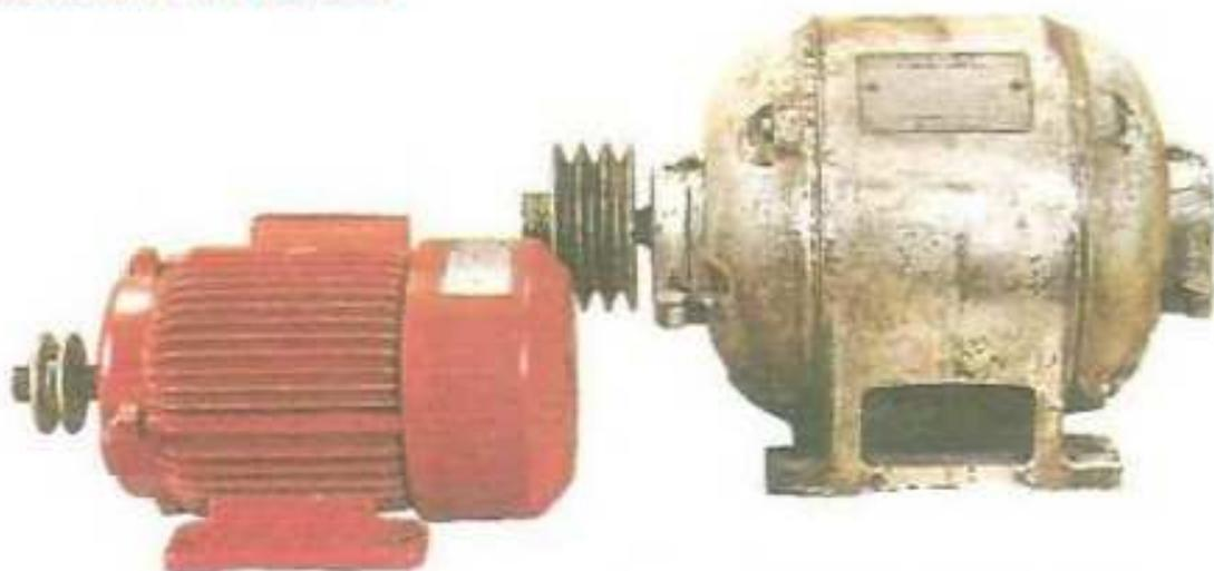
Los motores trifásicos arrancan por sí mismos. No tienen bobinas de arranque ni condensadores ni apagadores centrífugos u otros accesorios de arranque. Pueden arrancar cargas pesadas y son relativamente baratos. La corriente que usan es trifásica o de tres fases, o hilos de 120 volts, que generalmente se llaman A, B y C.
