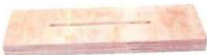
Para fijar ambos moldes se necesita una tabla con una ranura en el centro por la que quepa el tornillo.
