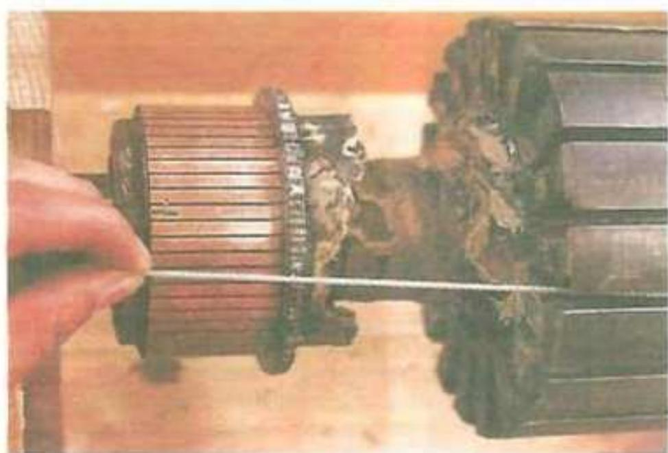
Mida la distancia entre el borde de las ranuras y el colector, así como entre el borde del colector y el extremo del eje, y marque la alineación de las delgas respecto a las ranuras.
