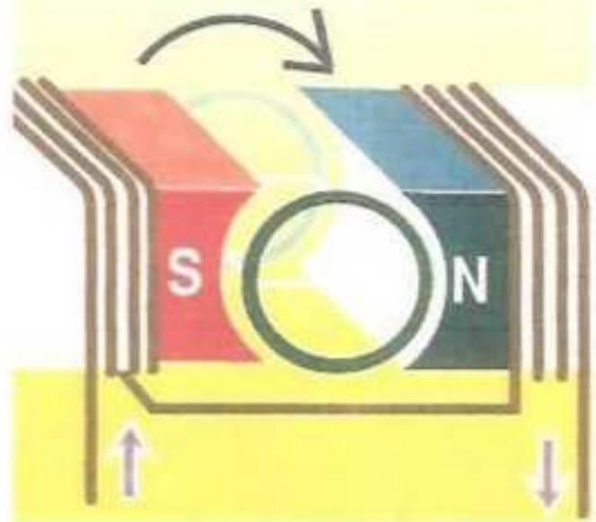
El flujo de corriente produce líneas de fuerza magnéticas que se posan alrededor de las barras del rotor, en un movimiento circular. Como resultado, las barras del rotor se mueven hacia el área de menor resistencia, con el campo más débil girando constantemente.
