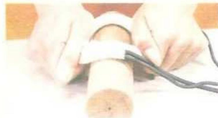
A continuación se da a la bobina la forma conveniente para que ajuste sobre el polo.
