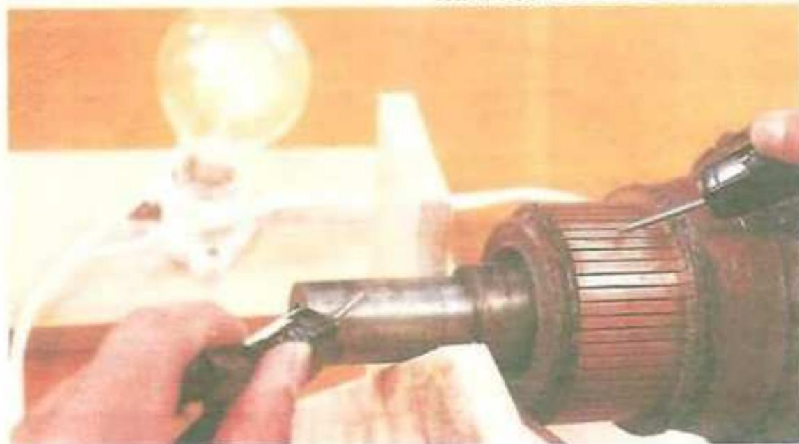
Si esa delga está perfectamente aislada, la lámpara permanecerá apagada. Pero si se enciende, indicará que la delga está a tierra. El contacto a tierra de la delga generalmente ocurre contra el núcleo, debido a una arandela defectuosa que hay que cambiar.
