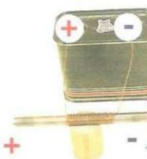
Cuando los cables que salen de la batería se intercambian, se cambia también la dirección en que corre la corriente y se invierten los polos del electroimán, de modo que los polos iguales vuelven a quedar juntos de nuevo y el imán libre es rechazado o empujado, con lo que continúa dando vuelta.
