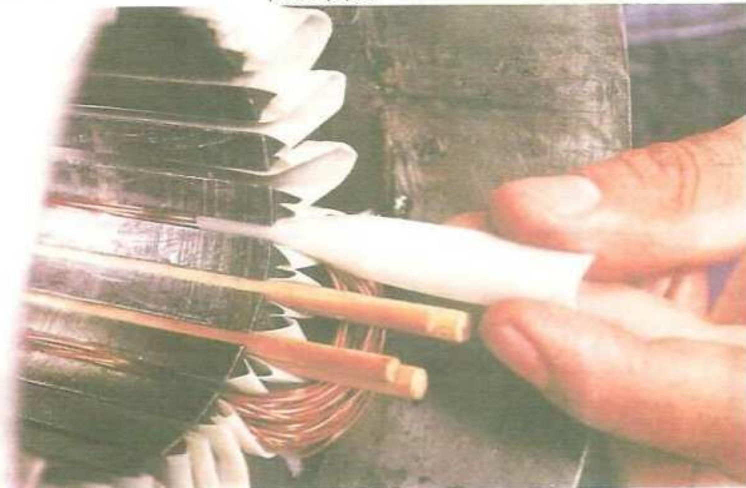
Los caballetes se meten en la parte superior de las ranuras embobinadas, deslizándolos para que actúen como separadores entre las bobinas de trabajo y las bobinas de arranque, que se colocarán después.
