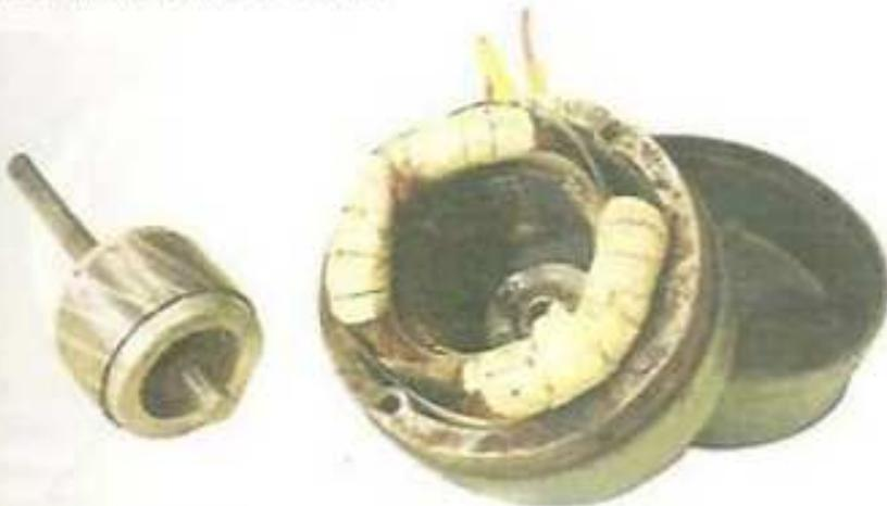
Los motores equipados con rotores de jaula de ardilla se conocen como motores de inducción. Solamente el estator tiene conexiones eléctricas exteriores. El rotor no tiene conexiones eléctricas, puesto que la corriente del rotor es inducida.
