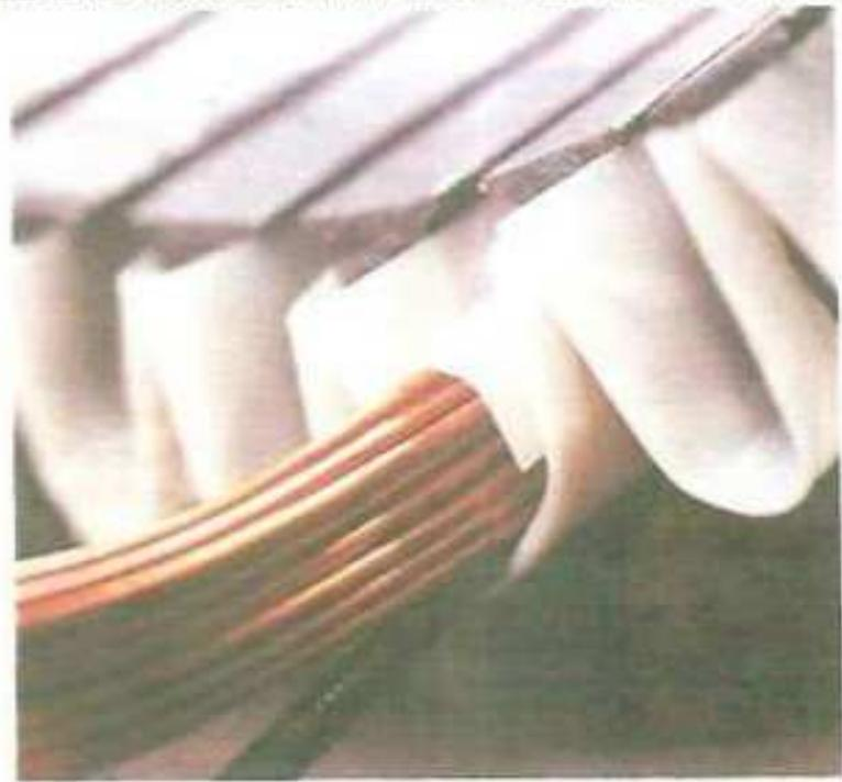
Se debe tener la seguridad de que todos quedan dentro del aislamiento, para que no haya peligro de un contacto a tierra. Enseguida, se presionan suavemente con los dedos para que todos los alambres queden en el fondo de la ranura y se pone un caballete de material aislante.
