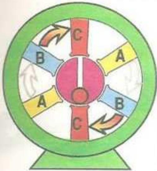
Enseguida, los polos C se magnetizan por la fase C y el rotor sigue girando.
