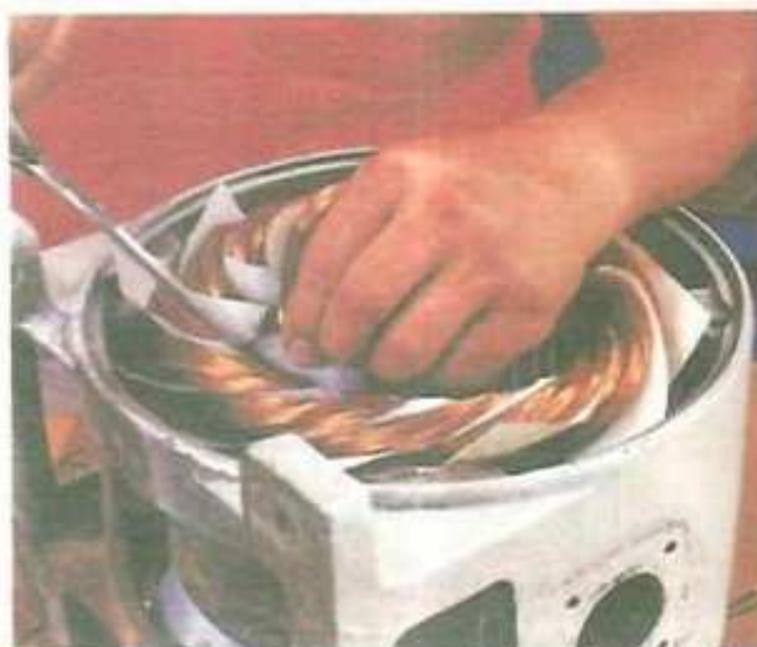
Enseguida, se recortan los sobrantes de aislante que se colocaron para separar las bobinas de cada fase.
