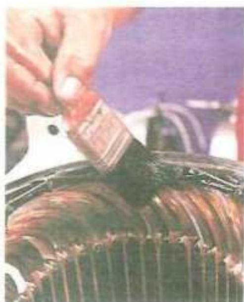
Finalmente, se barniza el embobinado y se deja secar, antes de volver a armar el motor.
