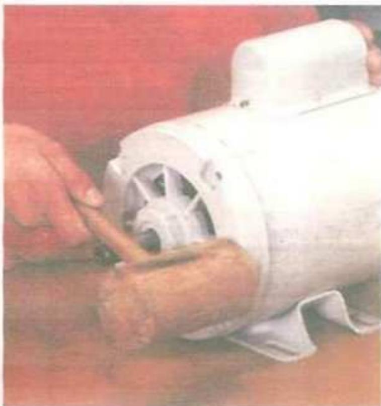
Si las tapas no están bien colocadas, los baleros quedan desalineados. Entonces puede ser difícil o imposible que el eje gire. Cuando una tapa está bien ajustada y se golpea con un mazo, tiene un sonido limpio. Si suena hueco es necesario aflojar todas las tuercas y volverlas a apretar poco a poco cada vez y de manera alternada para que la tapa vaya entrando derecha.
