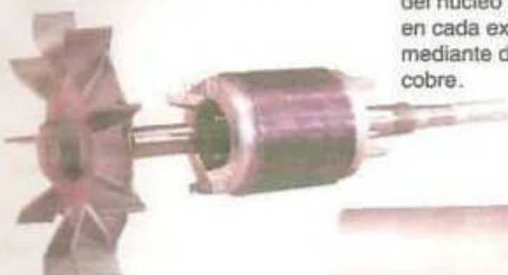
Algunas veces el rotor también lleva un ventilador montado sobre el eje.
