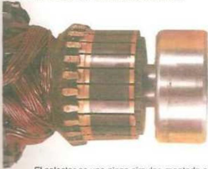
El colector es una pieza circular, montada en el eje, hecha con numerosas láminas de cobre, llamadas delgas, aisladas unas de otras con unas micas intermedias generalmente más bajas que las delgas y aisladas también del eje.
