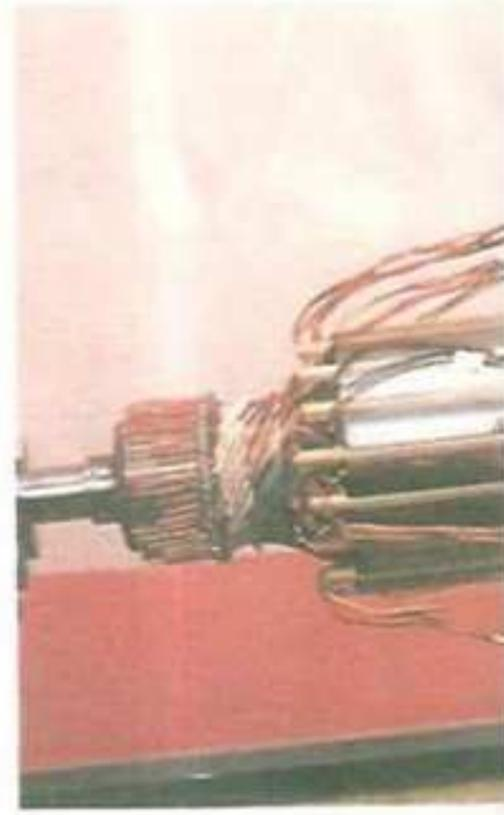
De ese modo se terminan de colocar todos los inicios de bobina.
