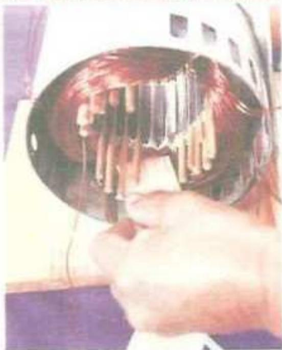
Con un trozo de madera se presionan las cabezas de las bobinas de arranque con el fin de que no sobresalgan en exceso.
