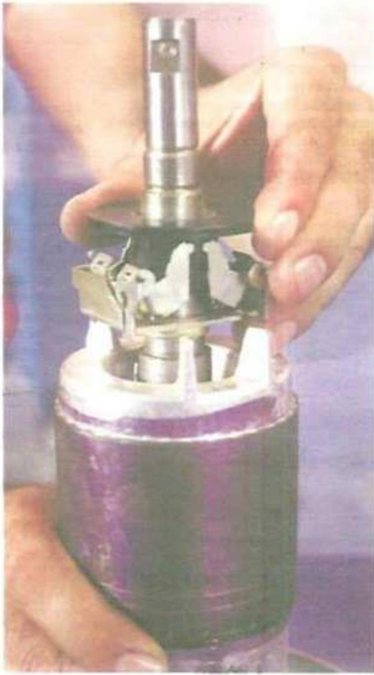
El interruptor centrífugo va adentro del armazón. Este apagador se cierra automáticamente cuando el motor está quieto o trabaja a baja velocidad, pero se abre a velocidades altas.
