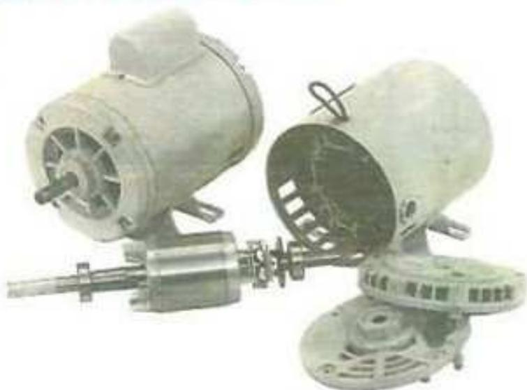
Los motores con condensador para el arranque son quizá los más comúnmente usados en las casas y en las industrias. Se usan cuando se necesita arrancar con cargas ligeramente más pesadas y se consiguen en capacidades que van desde un tercio de caballo hasta 25 caballos de fuerza. El condensador puede localizarse en la parte de arriba del motor o en un lado.
