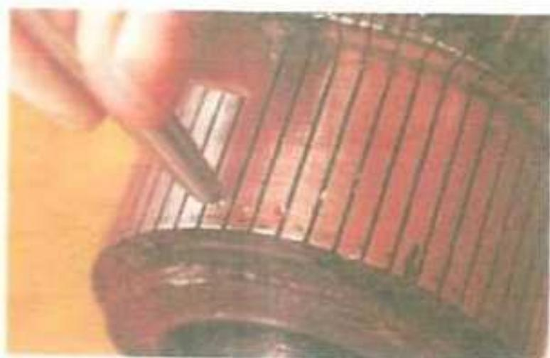
Con un marcador de golpe se marcan las delgas a las cuales llegan los alambres finales de esa primera bobina. De esa manera se conoce el paso de los alambres finales de la bobina. Posteriormente, cuando se termine de sacar el alambre de esa bobina, se conocerá el paso de los alambres iniciales.
