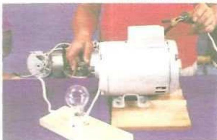
El contacto a tierra se determina con la lámpara de prueba colocándola en la forma que se explica en la página 40.
