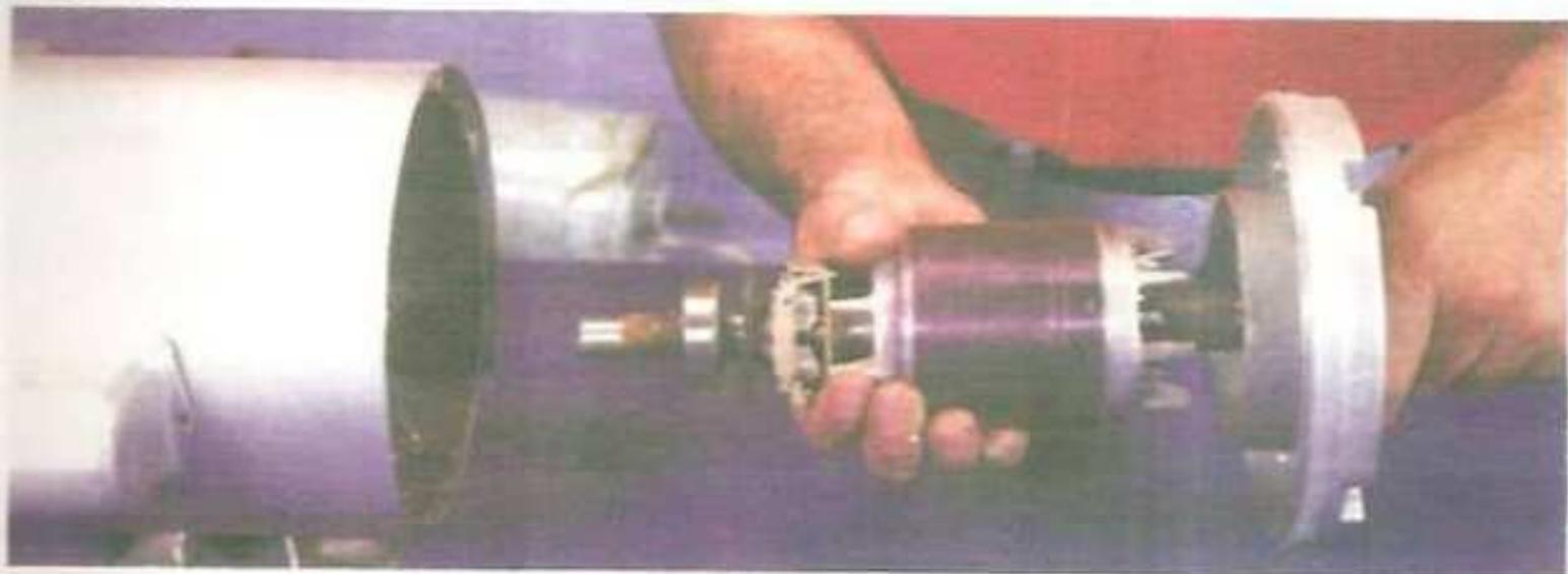
Luego, con mucho cuidado para no deteriorar las bobinas que se encuentren en buen estado, hay que sacar el rotor.
