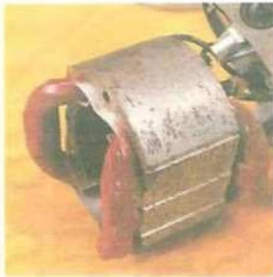
El estator o inductor consiste en un paquete de láminas circulares prensadas, fijadas con remaches, que en su interior tienen unos polos salientes con la forma necesaria para recibir, generalmente, un solo par de bobinas inductoras.
