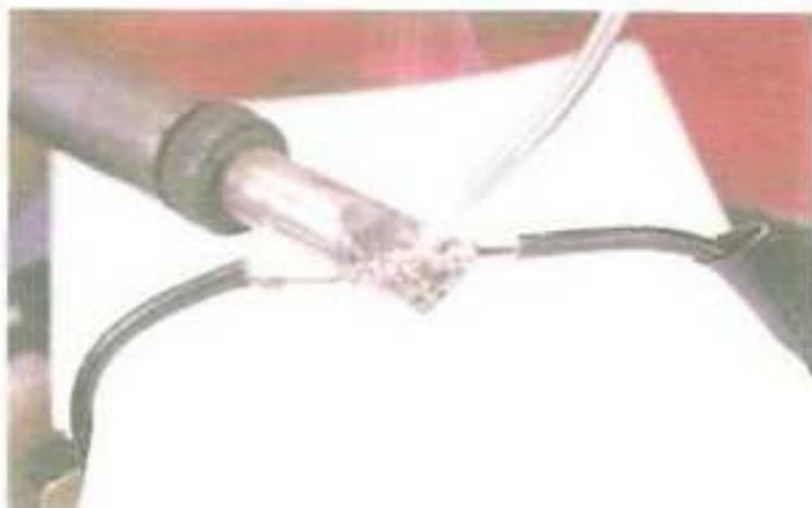
Cada conexión debe soldarse. Para ello caliente el caudín y cubra la superficie del conductor con resina o pasta. Funda la soldadura de estaño sobre el conductor manteniendo la punta del caudín en contacto con la unión.
