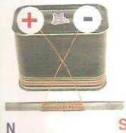
Los polos del electroimán se pueden invertir al cambiar la dirección de la corriente que viene de la batería, intercambiando los cables.
