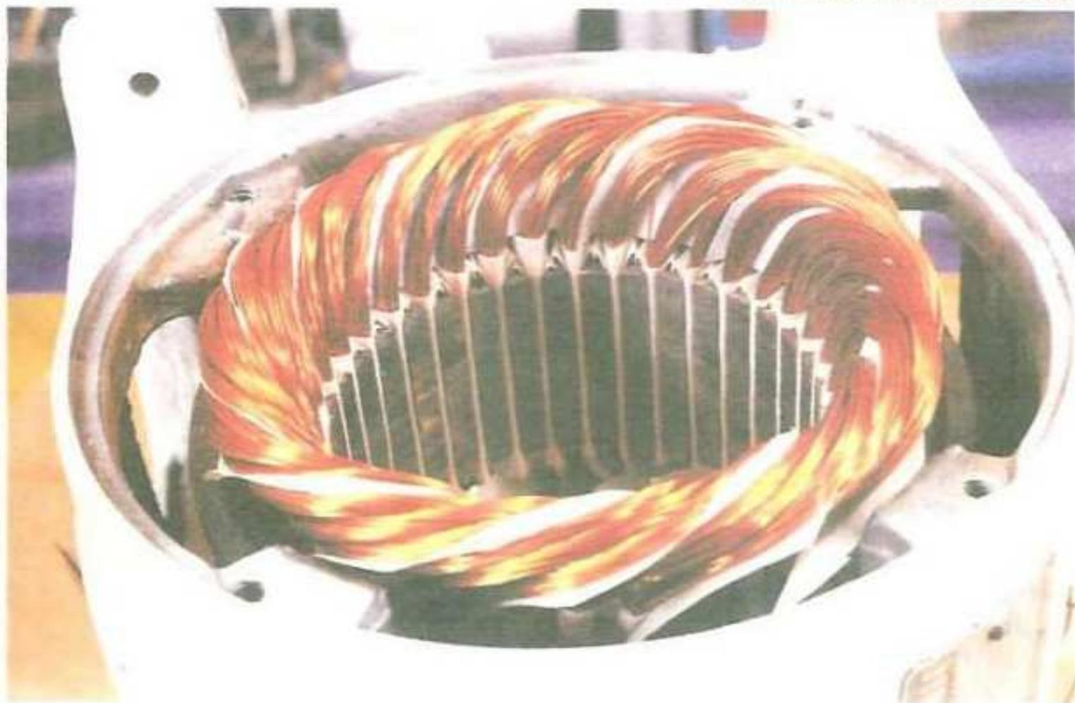
De ese modo el bobinado queda listo para el terminado, que consiste en afirmarlo como una masa compacta y hacer las pruebas necesarias para verificar su estado correcto.
