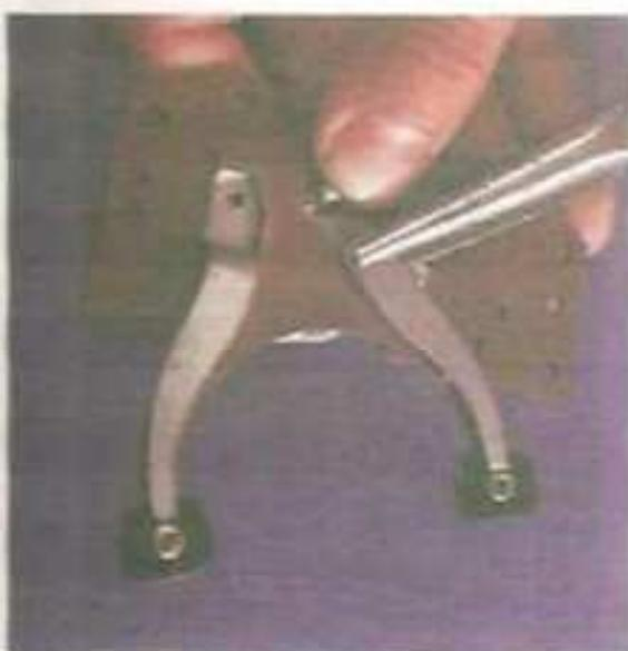
A continuación se calibran los platinos para que tengan una "luz" o separación de 2 mm. Para ajustarlos, las láminas de regulación se doblan con unas pinzas de punta.
