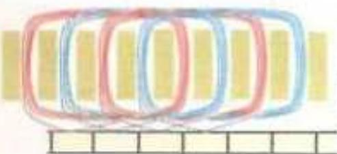
Ya que se termina el bobinado, los finales de las delgas se conectan a la delga donde está el inicio de la bobina siguiente.
