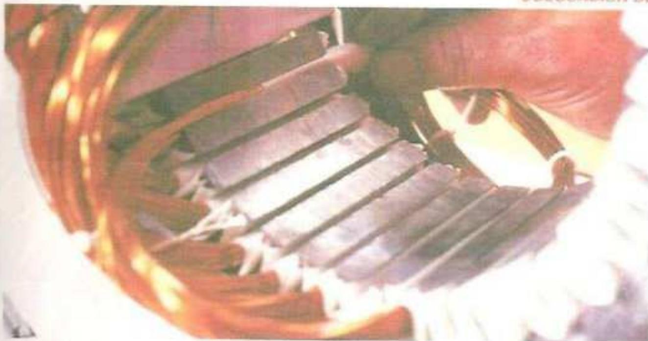
Cuando la segunda ranura en la que debe entrar una bobina ya tiene bobina abajo, entonces se puede meter el otro lado de cada bobina, quedando siempre en la parte superior de la ranura.
