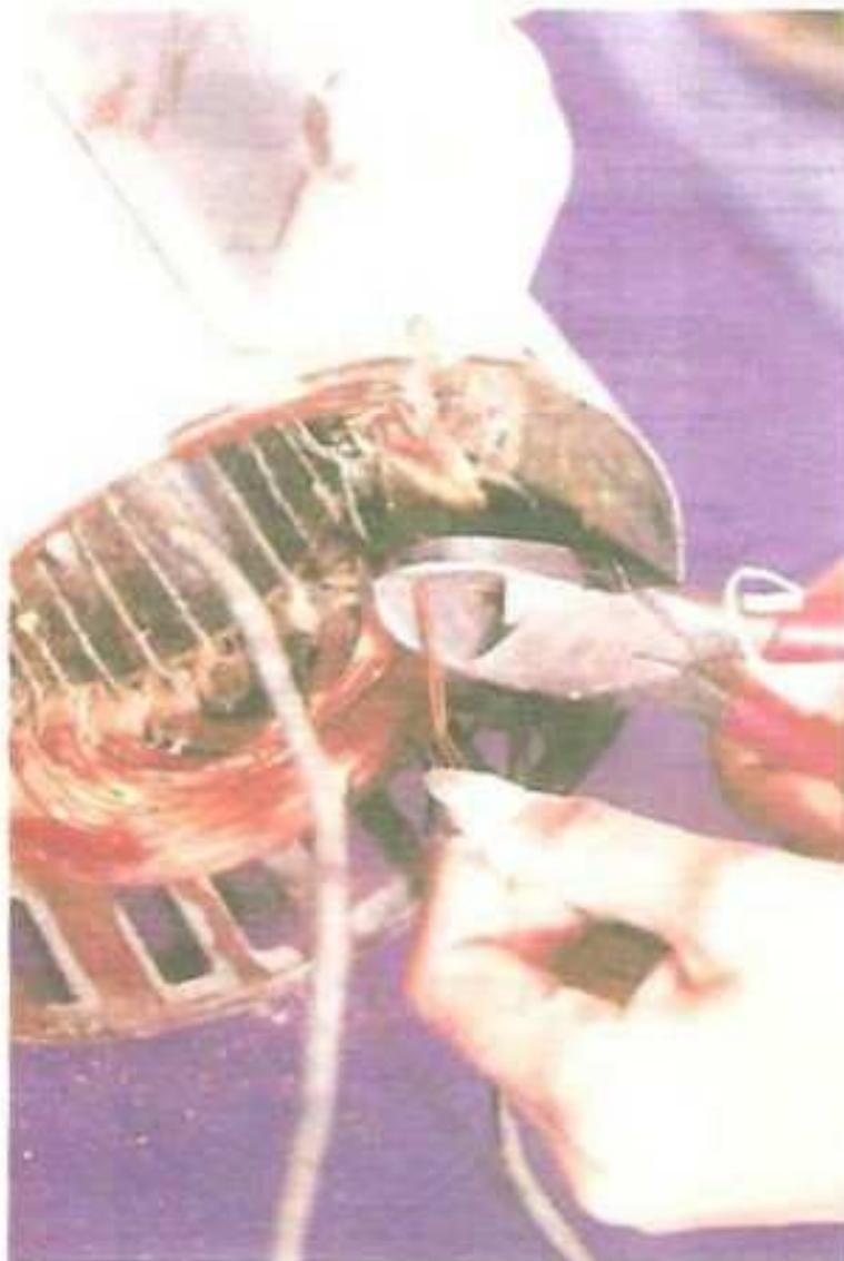
Ahora, hay que averiguar el diámetro del conductor de cada bobina. Para ello, con unos alicates se corta un alambre de una bobina de arranque y otro de una de trabajo.
