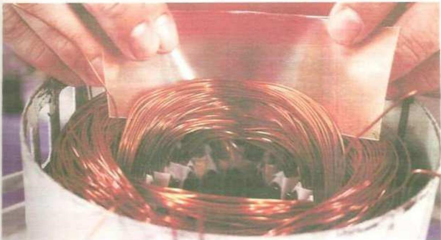
Enseguida, entre las cabezas de las bobinas de arranque y las de trabajo se coloca una tela aislante de fibra de vidrio.
