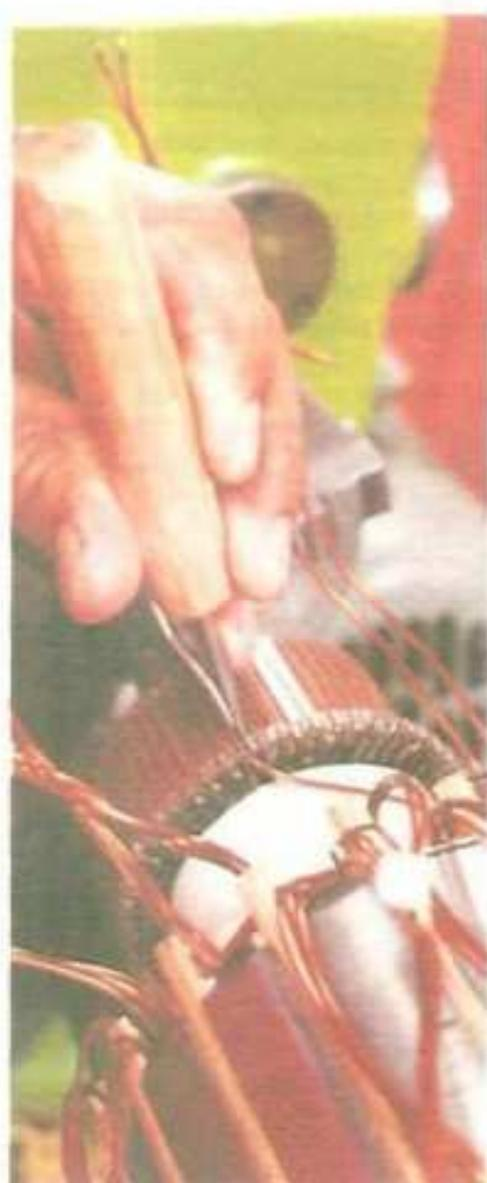
Coloque ese extremo pelado del alambre dentro de la muesca y golpee suavemente con un buril plano.
