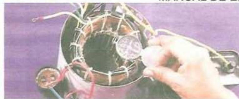
Enseguida, antes de hacer el secado y la impregnación del nuevo embobinado, se hacen pruebas de tierra, de continuidad, de cortocircuito y de polaridad, para detectar fallas. Para probar si las bobinas tienen la polaridad correcta, se conecta el motor a una batería o pila eléctrica y se pasa una brújula sobre cada uno de los polos, en el interior del estator.
