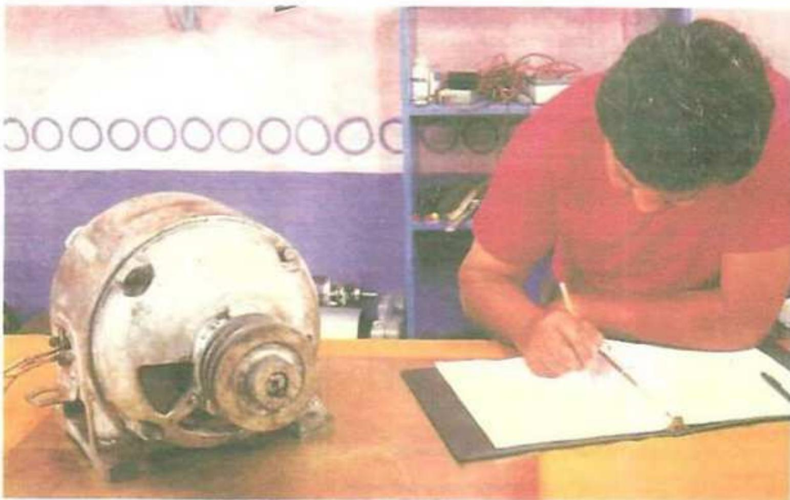
Los datos que se deben anotar en primer lugar son los que aparecen en la placa. Además, antes de desarmar el motor y cortar las terminales se debe registrar el número de ranuras, el número de bobinas, la clase de conexión entre bobinas, el número de vueltas de cada bobina, la forma y tamaño de cada bobina, el paso de la bobina, la clase de aislamiento de las ranuras y el calibre del alambre magneto, así como el espesor de su aislamiento.
