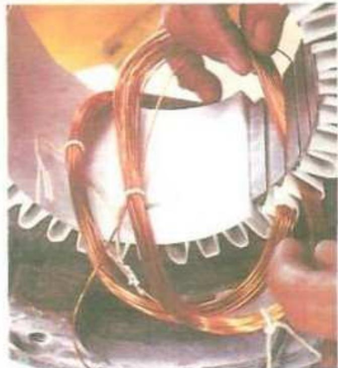
En la ranura de junto se mete un lado de la segunda bobina. Así se sigue hasta casi terminar con todas. Se coloca una tira de material aislante encima de las ranuras, para separarlas de las bobinas que van a ir abajo.
