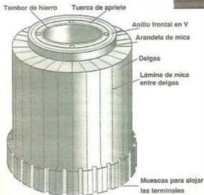
Para corregir el cortocircuito es necesario desbaratar el colector desenroscando la tuerca que lo mantiene apretado. Luego las delgas se golpean suavemente con un martillo, para que salte el anillo y las delgas queden libres.
