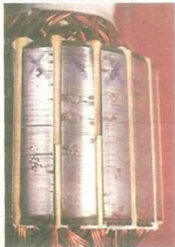
Para que el bobinado del rotor no se deteriore por la humedad ni por la vibración, se impregna con barniz.
