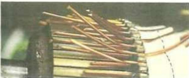
Y se finaliza con la manera en que se sueldan algunas terminales y se fijan con un zunchado de cordel y alambre.
