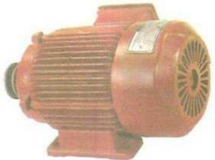
Los motores blindados o cerrados están hechos para trabajar donde hay polvo o humedad. Para enfriarlos, el calor se transmite a la armazón, que tiene unas nervaduras externas o aletas, que al contacto con el aire disipan el calor.
