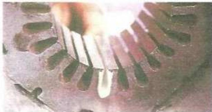
Sigue con la colocación de los aislantes sobre los cuales se va a recibir el alambre magneto de las nuevas bobinas.
