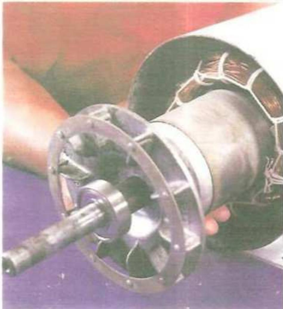
Ya con las conexiones hechas y las cabezas de las bobinas amarradas, se procede a hacer las conexiones a la placa de bornes y al condensador.
