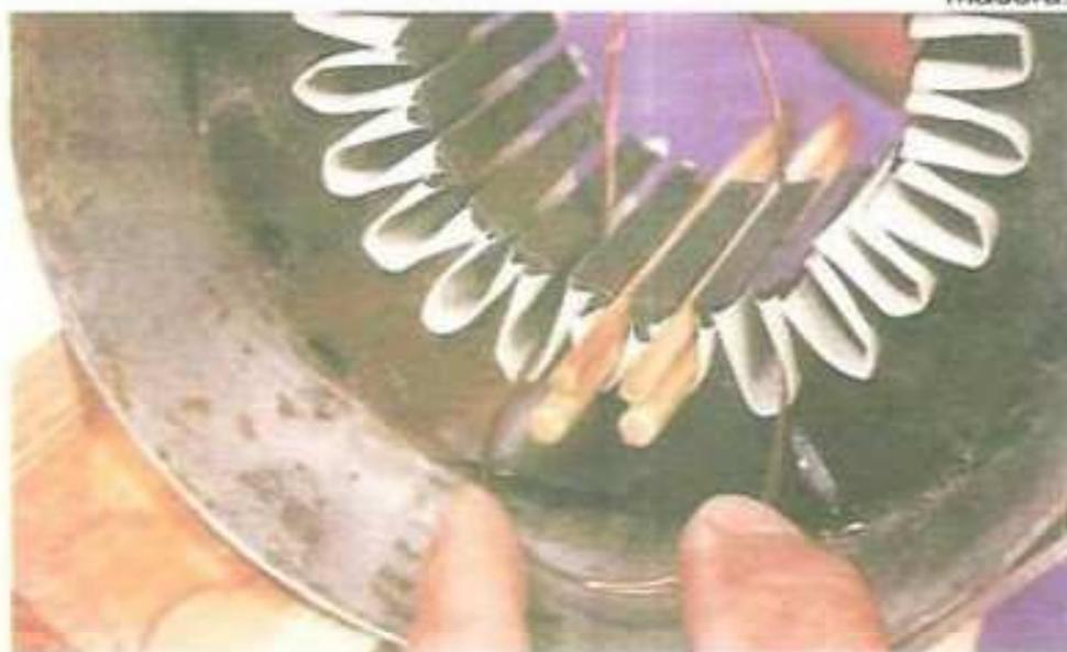
El bucle se mete por en medio del núcleo, para pasar al otro lado del motor.
