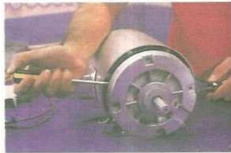
Algunas veces es necesario hacer palanca con un par de destornilladores, a fin de que el balero corra dentro del eje.
