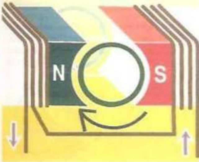
Un vistazo cercano a un estator de dos polos con un rotor de una barra permite comprender todo más fácilmente. La corriente alterna que corre por el estator hace que los polos cambien de polaridad rápidamente. Si al rotor se le da una vuelta, las barras cortan las líneas de fuerza magnética del estator, haciendo que la corriente fluya, pase o se induzca a la barra del rotor.
