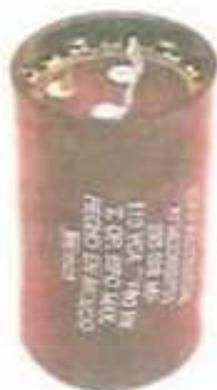
Igual que las bobinas de arranque, los condensadores de arranque son desconectados por el interruptor centrífugo cuando el motor está cerca de su velocidad normal. En estos motores el embobinado de arranque, el interruptor centrífugo y el condensador van conectados en serie.
