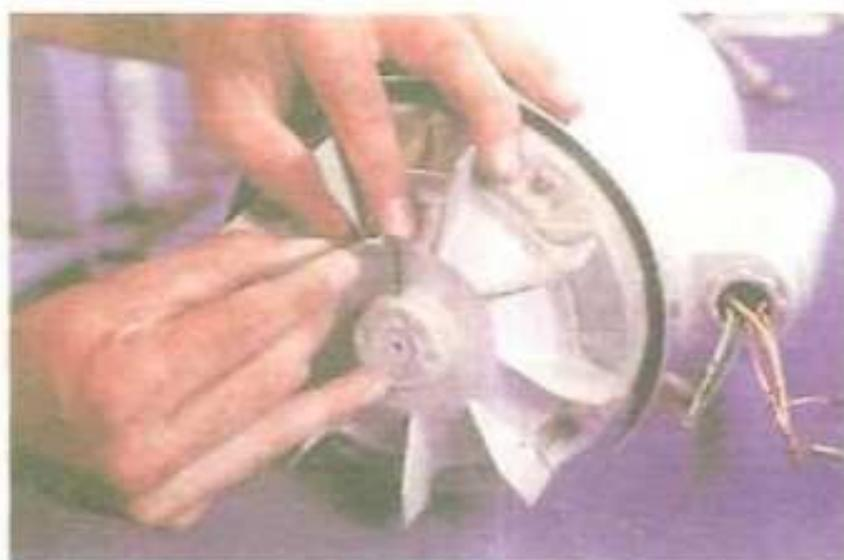
Si el motor tiene ventilador, se retira enseguida.
