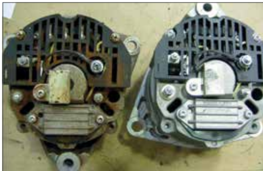
Fig. 4.06 - Componentes en posición incorrecta.
