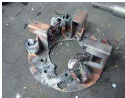
Fig. 2.02 - Colector y portaescobillas totalmente destruidos.
