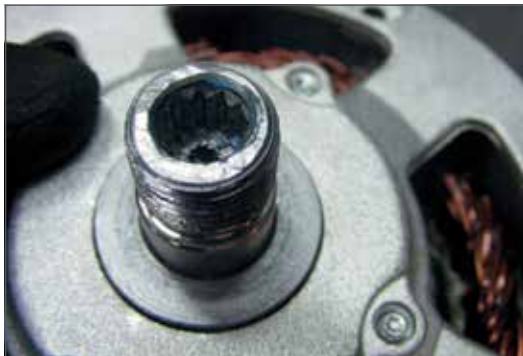
Fig. 4.07 - Rosca del eje dañada.
