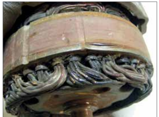
Fig. 3.05 - Bobina del estator quemada.
