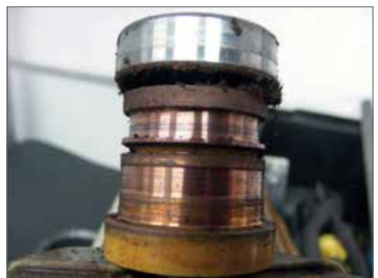
Fig. 1.05 - Desgaste de los anillos colectores.
