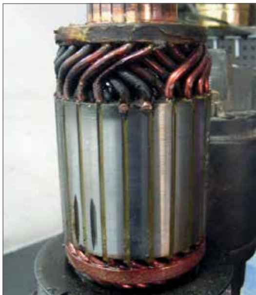
Fig. 2.03 - Daño en los filamentos del inducido.
