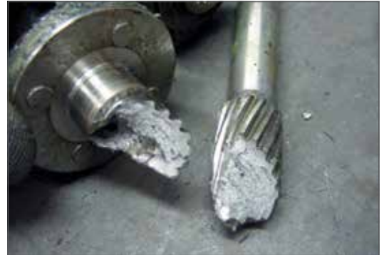
Fig. 7.03 - Rotura del eje del inducido o del reductor (si el motor de arranque tiene).
