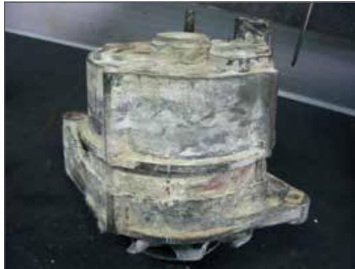
Fig. 1.06 - Acumulación en exceso de contaminantes.
