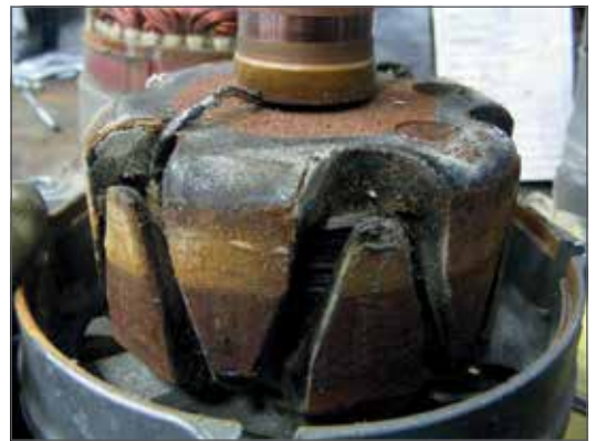
Fig. 3.04 - Bobina del rotor rota o quemada.
