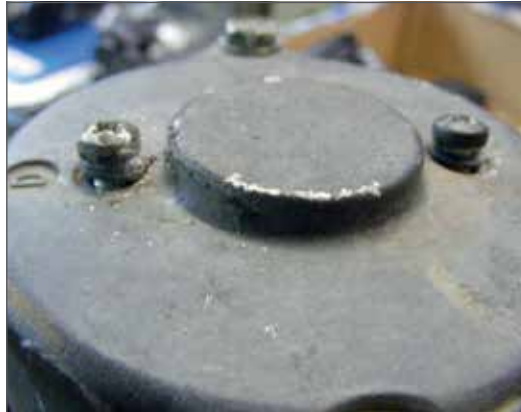
Fig. 6.03 - Evidencia de adulteración de las condiciones originales del producto.
