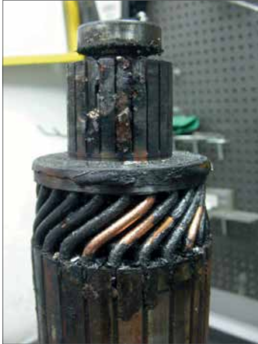
Fig. 3.03 - Expansión y pérdida de aislación de los filamentos del inducido.
