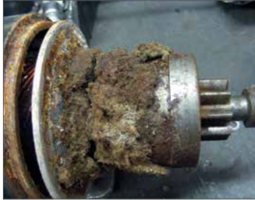
Fig. 4.02 - Bloqueo del movimiento de avance, rotación y retorno del impulsor.
