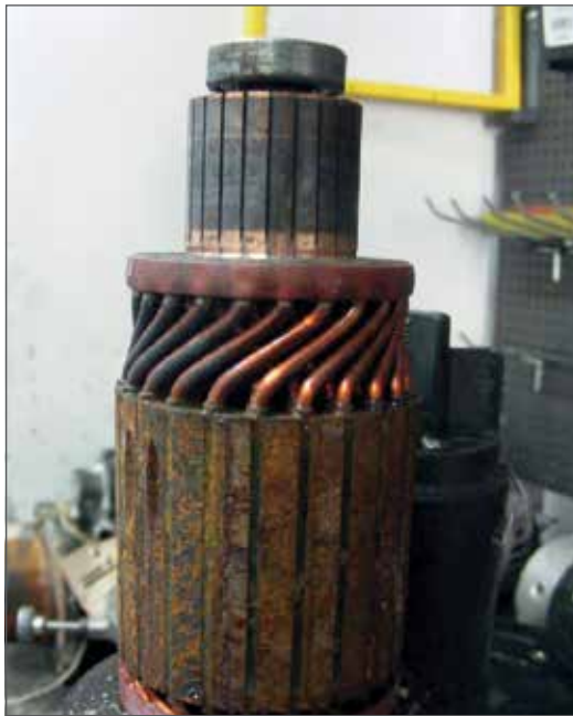
Fig. 5.01 - Oxidación de la armadura del inducido.
