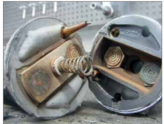
Fig. 5.04 - Oxidación de los contactos internos del solenoide.
