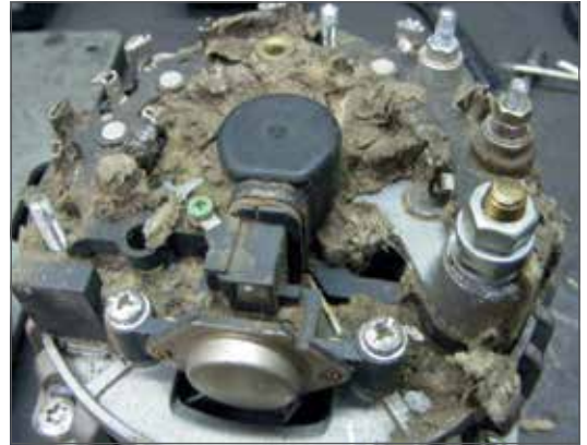
Fig. 1.03 - Cortocircuito o quema del puente rectificador.
