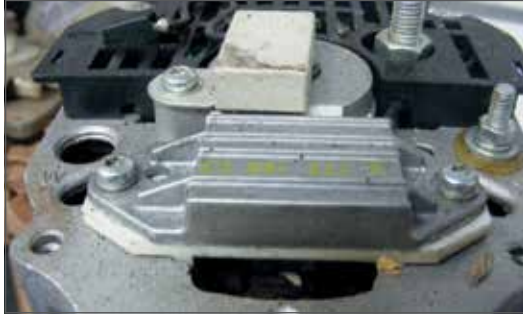
Fig. 4.04 - Falta de terminales en el alternador.
