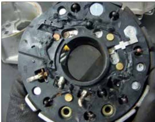
Fig. 1.02 - Cortocircuito o quema del puente rectificador.
