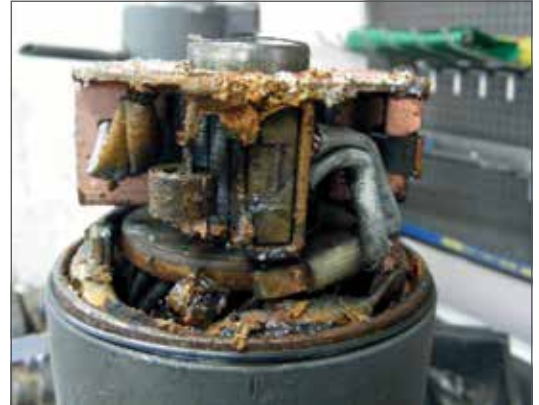
Fig. 5.03 - Oxidación del portaescobillas.
