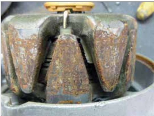
Fig. 5.01 - Oxidación de la carcasa del rotor.
