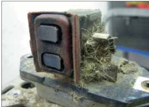
Fig. 1.01 - Escobillas del regulador bloqueadas.
