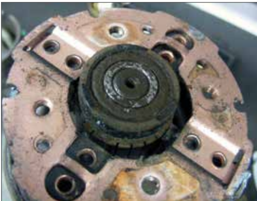
Fig. 4.01 - Ruido y desgaste prematuro de los rodamientos.
