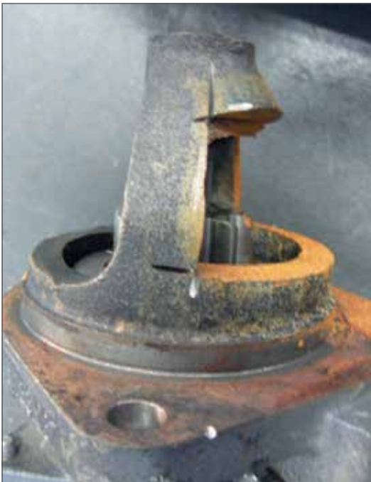
Fig. 6.02 - Evidencia de adulteración de las condiciones originales del producto.
