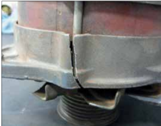
Fig. 6.01 - Rotura de componentes.
