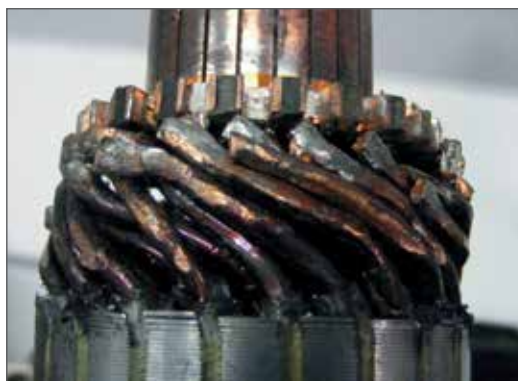
Fig. 3.02 - Rompimiento dos filamentos do inducido.
