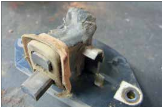
Fig. 3.01 - Regulador de tensión quemado.
