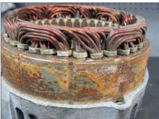
Fig. 5.02 - Oxidación del armazón del estator.
