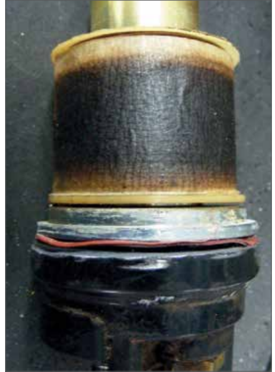
Fig. 3.05 - Bobina interna del solenoide quemada.
