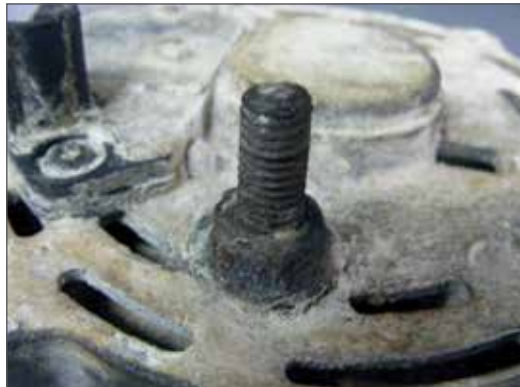
Fig. 5.04 - Oxidación de los terminales.
