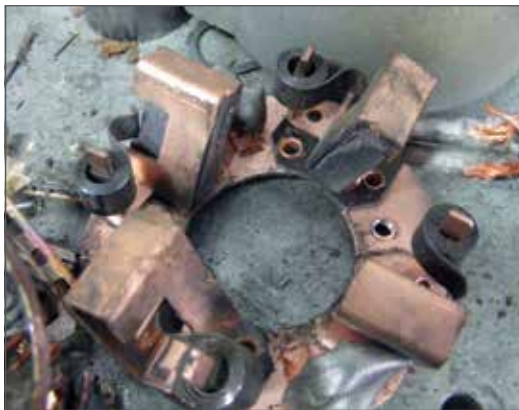
Fig. 3.04 - Posible destrucción del portaescobillas.
