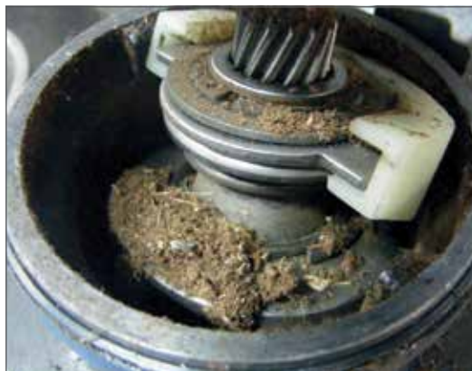
Fig. 4.04 - Bloqueo del movimiento del solenoide y palanca de acople.
