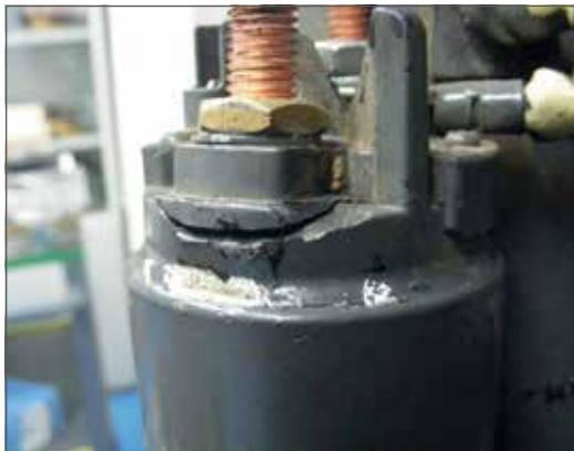
Fig. 7.01 - Rotura de componentes.
