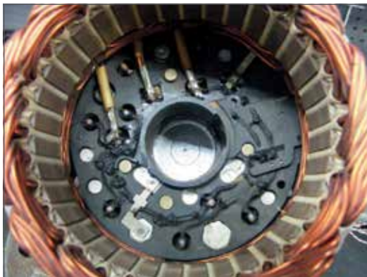
Fig. 3.02 - Diodos positivos rotos o quemados.
