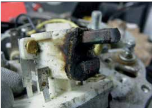
Fig. 2.01 - Escobillas del regulador de tensión quemadas.
