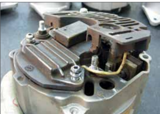
Fig. 4.01 - Evidencia de adulteración de las condiciones originales del producto.
